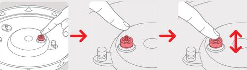
Vérifiez que le piston de la soupape de sécurité soit mobile (appuyez plusieurs fois ce piston avec l'index).
